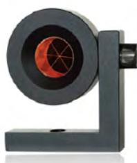
Prisma con supporto a "L", D=25,40mm
