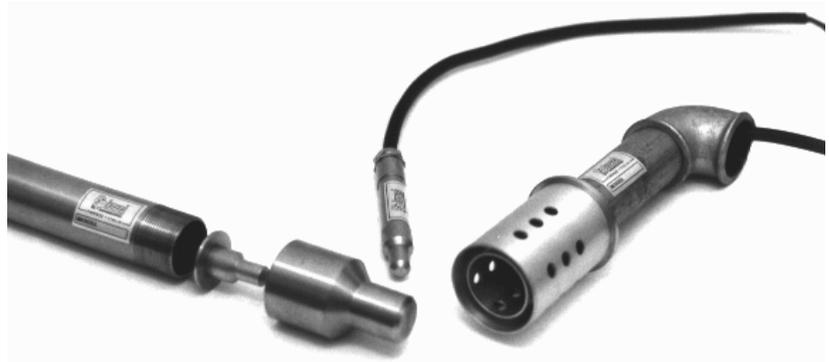
gradiente termico. Presi due conduttori o semiconduttori di materiali diversi e uniti ad una estremità, se questa viene sottoposta ad un gradiente di temperatura, ai capi dei due conduttori si genera una differenza di potenziale proporzionale alla temperatura applicata. Per la misura richiedono apposite centraline specifiche per questi sensori.
