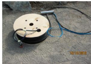
Coppia di tubi in rislan raccolti in guaina pvc e cavo collegamento sensore tipo 2 x 2 x 0,35 mm<sup>2</sup> con guaina in pur e rinforzo in kevlar, con inglobato tubetto rislan per compensazione pressione atmosferica
