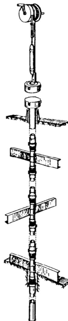
La misura ripetuta nel tempo fornisce così non solo gli assestamenti del materiale di ogni singolo strato e quindi dell'intero rilevato, ma anche la misura dell'assestamento della fondazione; è sufficiente per questo abbinare alla misura con la sonda una misura periodica della posizione della testa della colonna con rilievo topografico.
