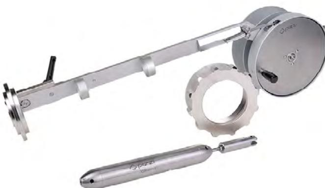
La misura ripetuta nel tempo fornisce così non solo gli assestamenti del materiale di ogni singolo strato e quindi dell'intero rilevato, ma anche la misura dell'assestamento della fondazione; è sufficiente per questo abbinare alla misura una misura periodica della posizione della testa della colonna con rilievo topografico.
