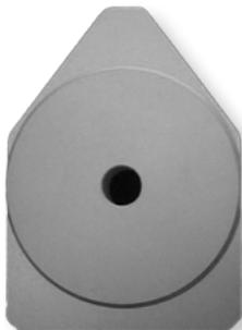
**Dispositivo di raccordo fra base collimatore e teodolite , caposaldo di livellazione, prisma e segnale ad asta.**
